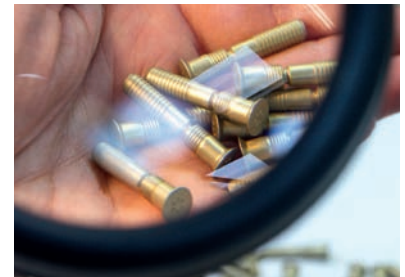
Befestigungselemente mit einer IVD-Aluminiumbeschichtung
