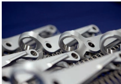
IVD-Aluminium-beschichtete Bauteile mit Maskierung im inneren Durchmesser. Nach der Beschichtung erfahren die Bauteile eine Chrom(III)-haltige Passivierung.
