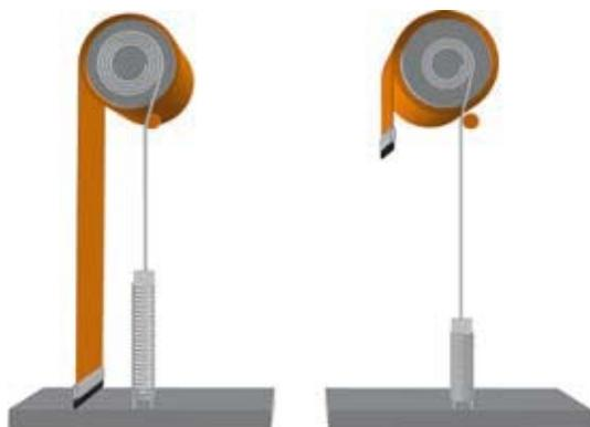
*In den Seitenzargen sind Zugfedern installiert, die über Schwerlastgurte direkt mit der Antriebswelle verbunden sind. Die Federn sind in "Tor-zu-Position" gespannt (links) und in "Tor-auf-Position" entspannt.*
