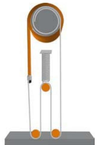
*Das Windlastsystem von EFAFLEX sorgt für permanente Torblattspannung. Perfekt immer da, wo Wind oder Unterdruck Zugluft verursachen!*
